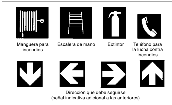
Figura 1. Señales de equipos de lucha contra incendios según Real Decreto 485/1997
