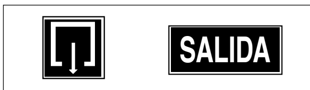
Figura 3. Señalización de salidas habituales según norma UNE 23034
