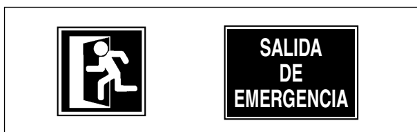
Figura 4. Señalización de salidas de emergencia según norma UNE 23034
